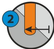
Важно расстояние от стены до конца газовой трубы. Если у пола есть утолщение, нужно мерить по нему.
